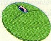
เมาส์ (Mouse) คือ อุปกรณ์รับข้อมูลที่อยู่ในรูปแบบคำสั่ง โดยการเลื่อนเมาส์ไปที่คำสั่งบนจอภาพ แล้วคลิกปุ่มซ้ายของเมาส์ เพื่อสั่งให้คำสั่งนั้นๆ ทำงาน เมาสมีหลายรูปแบบ ที่เห็นกันบ่อยๆ คือ แบบส่งข้อมูลผ่านสายสัญญาณ และแบบส่งข้อมูลผ่านตัวรับสัญญาณแบบไร้สาย
